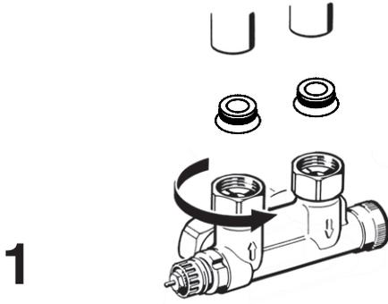
Die Voreinstellung kann in Stufen von 0,5 zwischen 1 und 7 gewählt werden. Werkseinstellung "N" = Spülmöglichkeit.
